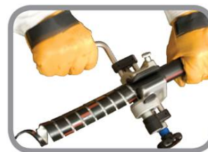
Außenmantel entfernen Removing outer sheath
