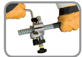
Isolierung schälen Peeling Insulation
