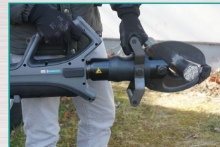
Der zusätzliche Handgriff erleichtert das Positionieren am Kabel The additional handle facilitates positioning at the cable
