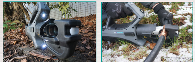
Helle Arbeitsfeldausleuchtung durch LED-Technologie
