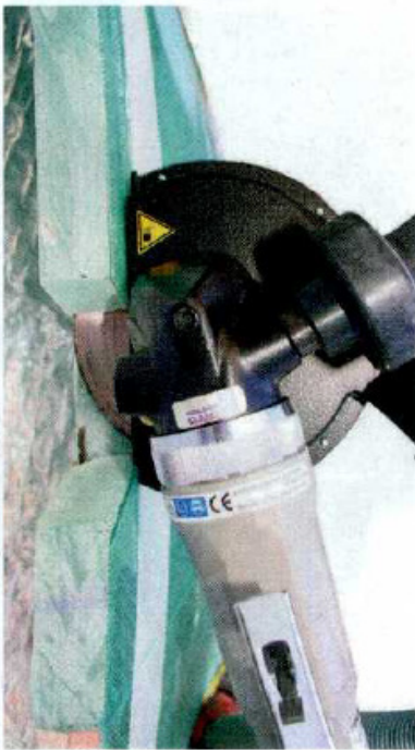
GFK-Schneider für die Bearbeitung von Rotorblättern aus glasfaserverstärktem Kunststoff. Die am Schneidwerkzeug integrierte Absaugung entfernt den Staub von der Schnittstelle.
