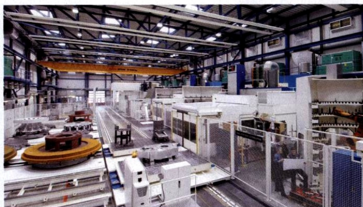
In einer klimatisierten Fertigungshalle werden bei der Schweizer Ruag hochpräzise Teile bis 25 t und mit Abmessungen bis 4,5 m hergestellt.
