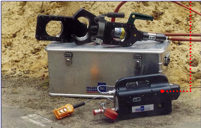
GIS-2 bestehend aus Akku-Pumpe REC-P 500 und Schneidkopf nach Wahl
