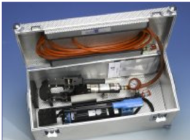
GIS-1/120 bestehend aus Fußpumpe FP 700-A und Schneidkopf PH 120-A-GIS
