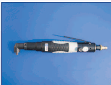
SW 15/5 A Winkelschrauber mit Abschaltkupplung Hebelventil, Drehrichtung umsteuerbar, 150 Watt Leistung, 90°-Winkel
