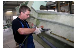
Fräs-, Schleif- und Entgratarbeiten erledigen Geradschleifer GG 40 sicher und mit hohen Standzeiten.
