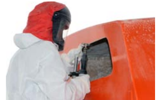
Gesundheitsschutz: Praktische, individuelle Modifizierungen wie spezielle Absaugungen ohne Einschränkung der Funktion und Sicherheit sind möglich (hier Geradschleifer GG 40).
