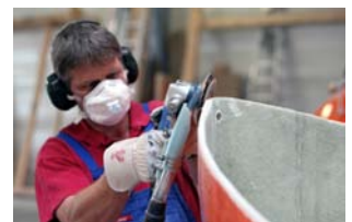
Polier- und Feinarbeiten werden an Flächen sowie Kanten der einzelnen Bootskörper mit dem Winkelschleifer DW 104 ausgeführt.
